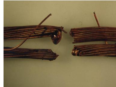
・過電流による発火、絶縁劣化や炭化による発火
