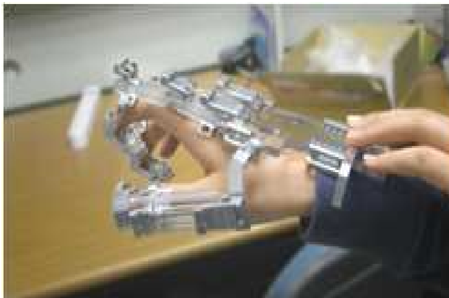
「図3 一体型ハプティックグローブ/触覚提示装置」
